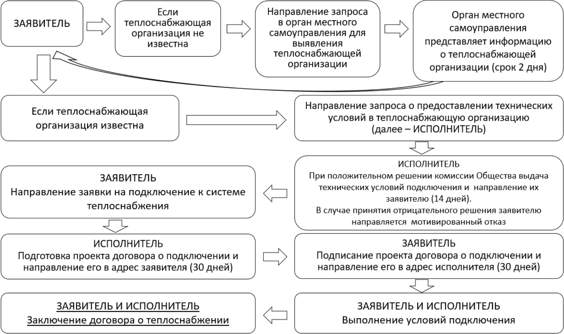
Блок-схема, отражающая графическое изображение последовательности действий, осуществляемых при подключении (технологическом присоединении)
